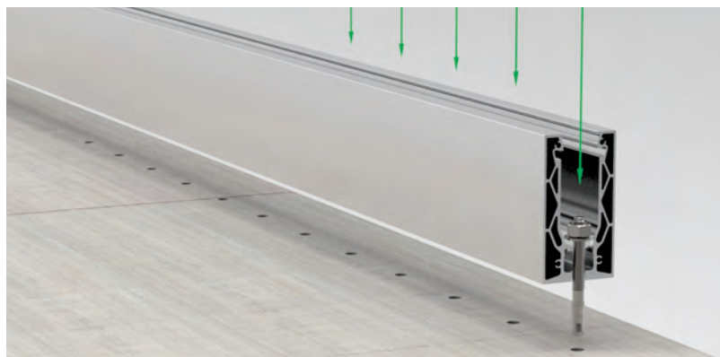
1. Profil anschrauben | Mount the profile
